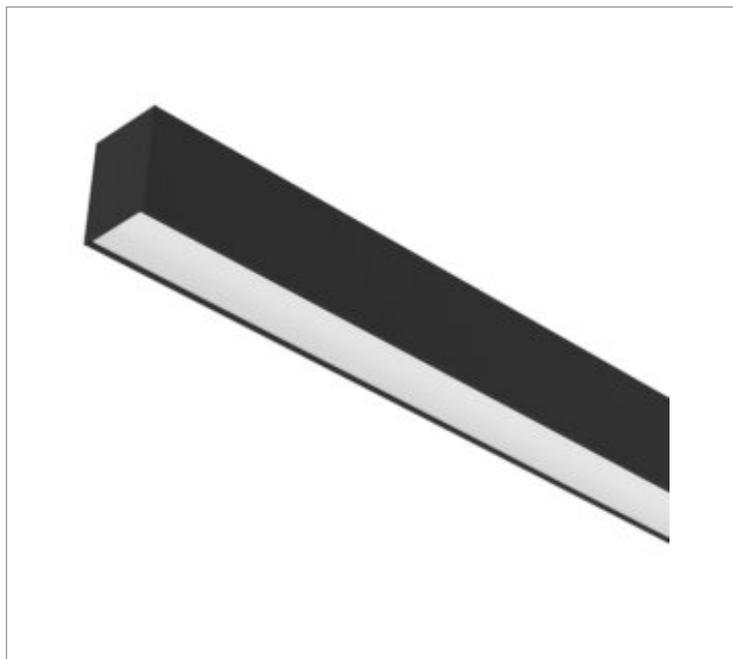
Luminária linear arandela iluminação direta, 37Wm 5000K IRC>80. Corpo em alumínio. Acabamento Branca, Preta ou Especial. Controle óptico principal através de difusor em poliestireno translúcido. Luminária grau de proteção IP-20ou65 (consultar condições). Driver corrente constante Liga/Desliga, Triac, 1-10V ou Dali (consultar condições). Tensão de trabalho 220V ou Bivolt.
