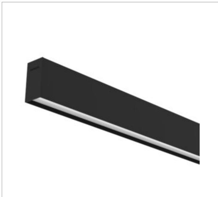
Luminária linear arandela iluminação direta e indireta, 2X25Wm 2700K IRC>80. Corpo em alumínio. Acabamento Branca, Preta ou Especial. Controle óptico principal através de difusor em acrílico translúcido. Luminária grau de proteção IP-20ou65 (consultar condições). Driver corrente constante Liga/Desliga, Triac, 1-10V ou Dali (consultar condições). Tensão de trabalho 220V ou Bivolt.
