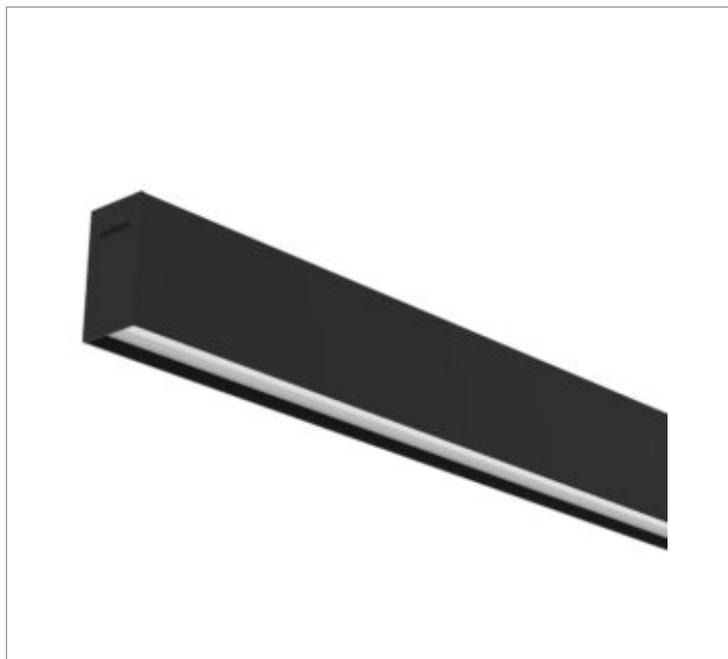
Luminária linear arandela iluminação direta e indireta, 2X37Wm 5000K IRC>95. Corpo em alumínio. Acabamento Branca, Preta ou Especial. Controle óptico principal através de difusor em poliestireno translúcido. Luminária grau de proteção IP-20ou65 (consultar condições). Driver corrente constante Liga/Desliga, Triac, 1-10V ou Dali (consultar condições). Tensão de trabalho 220V ou Bivolt.
