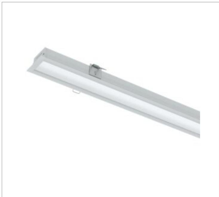
Luminária linear de embutir em forro de gesso, 25Wm 6500K IRC>80. Corpo em alumínio. Acabamento Branca, Preta ou Especial. Controle óptico principal através de difusor em acrílico translúcido. Luminária grau de proteção IP-20ou65 (consultar condições). Driver corrente constante Liga/Desliga, Triac, 1-10V ou Dali (consultar condições). Tensão de trabalho 220V ou Bivolt.
