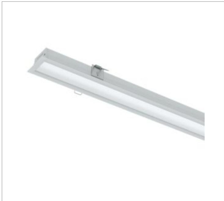
Luminária linear de embutir em forro de gesso, 37Wm 3000K IRC>80. Corpo em alumínio. Acabamento Branca, Preta ou Especial. Controle óptico principal através de difusor em acrílico translúcido. Luminária grau de proteção IP-20 ou 65 (consultar condições). Driver corrente constante Liga/Desliga, Triac, 1-10V ou Dali (consultar condições). Tensão de trabalho 220V ou Bivolt.
