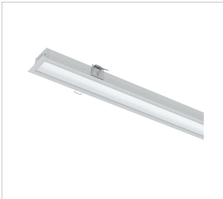
Luminária linear de embutir em forro de gesso, 37Wm 3000K IRC>80. Corpo em alumínio. Acabamento Branca, Preta ou Especial. Controle óptico principal através de difusor em poliestireno translúcido. Luminária grau de proteção IP-20. Driver corrente constante Liga/Desliga, Triac, 1-10V ou Dali (consultar condições). Tensão de trabalho 220V ou Bivolt.
