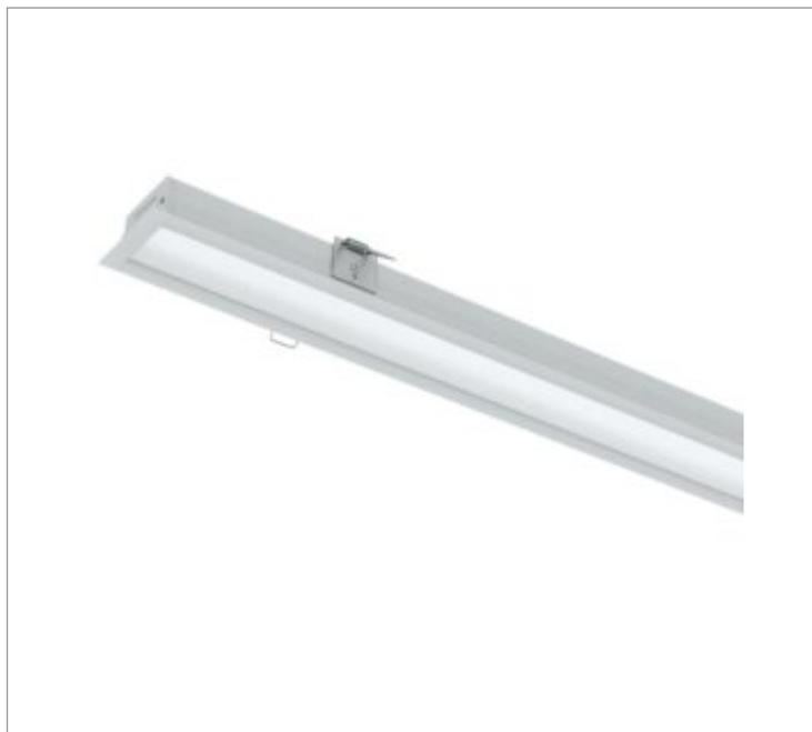
Luminária linear de embutir em forro de gesso, 37Wm 6500K IRC>80. Corpo em alumínio. Acabamento Branca, Preta ou Especial. Controle óptico principal através de difusor em poliestireno translúcido. Luminária grau de proteção IP-20ou65 (consultar condições). Driver corrente constante Liga/Desliga, Triac, 1-10V ou Dali (consultar condições). Tensão de trabalho 220V ou Bivolt.
