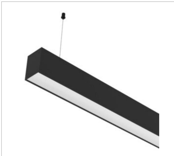
Luminária linear pendente iluminação direta, 15Wm 2700K IRC>80. Corpo em alumínio. Acabamento Branca, Preta ou Especial. Controle óptico principal através de difusor em acrílico translúcido. Luminária grau de proteção IP-20ou65 (consultar condições). Driver corrente constante Liga/Desliga, Triac, 1-10V ou Dali (consultar condições). Tensão de trabalho 220V ou Bivolt.
