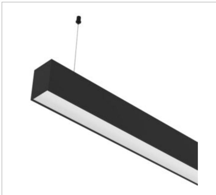
Luminária linear pendente iluminação direta, 37Wm 3000K IRC>80. Corpo em alumínio. Acabamento Branca, Preta ou Especial. Controle óptico principal através de difusor em poliestireno translúcido. Luminária grau de proteção IP-20ou65 (consultar condições). Driver corrente constante Liga/Desliga, Triac, 1-10V ou Dali (consultar condições). Tensão de trabalho 220V ou Bivolt.
