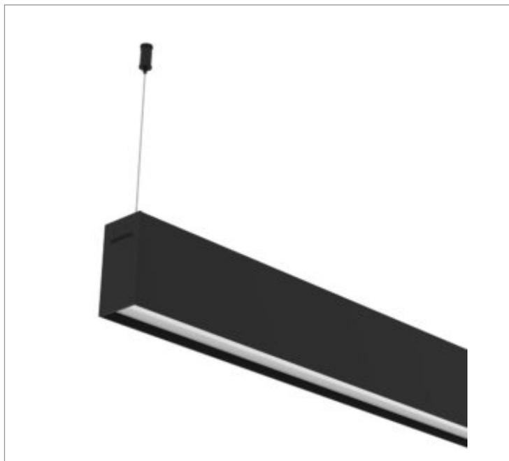
Luminária linear pendente iluminação direta e indireta, 2X25Wm 4000K IRC>95. Corpo em alumínio. Acabamento Branca, Preta ou Especial. Controle óptico principal através de difusor em acrílico translúcido. Luminária grau de proteção IP-20ou65 (consultar condições). Driver corrente constante Liga/Desliga, Triac, 1-10V ou Dali (consultar condições). Tensão de trabalho 220V ou Bivolt.
