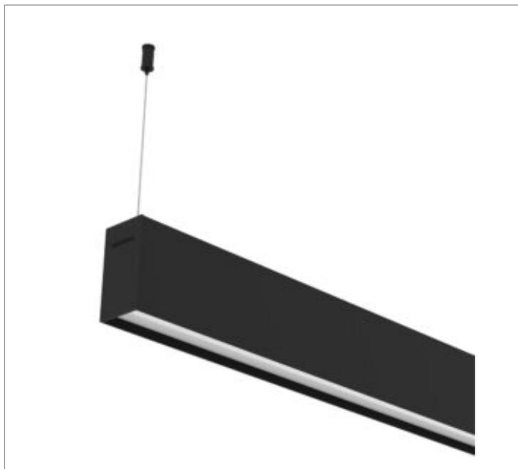
Luminária linear pendente iluminação direta e indireta, 2X37Wm 5000K IRC>95. Corpo em alumínio. Acabamento Branca, Preta ou Especial. Controle óptico principal através de difusor em poliestireno translúcido. Luminária grau de proteção IP-20ou65 (consultar condições). Driver corrente constante Liga/Desliga, Triac, 1-10V ou Dali (consultar condições). Tensão de trabalho 220V ou Bivolt.
