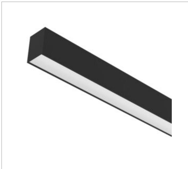
Luminária linear de sobrepôr, 15Wm 4000K IRC>80. Corpo em alumínio. Acabamento Branca, Preta ou Especial. Controle óptico principal através de difusor em poliestireno translúcido. Luminária grau de proteção IP-20ou65 (consultar condições). Driver corrente constante Liga/Desliga, Triac, 1-10V ou Dali (consultar condições). Tensão de trabalho 220V ou Bivolt.
