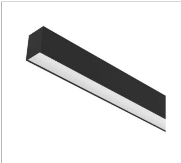
Luminária linear de sobrepôr, 25Wm 3000K IRC>95. Corpo em alumínio. Acabamento Branca, Preta ou Especial. Controle óptico principal através de difusor em poliestireno translúcido. Luminária grau de proteção IP-20ou65 (consultar condições). Driver corrente constante Liga/Desliga, Triac, 1-10V ou Dali (consultar condições). Tensão de trabalho 220V ou Bivolt.
