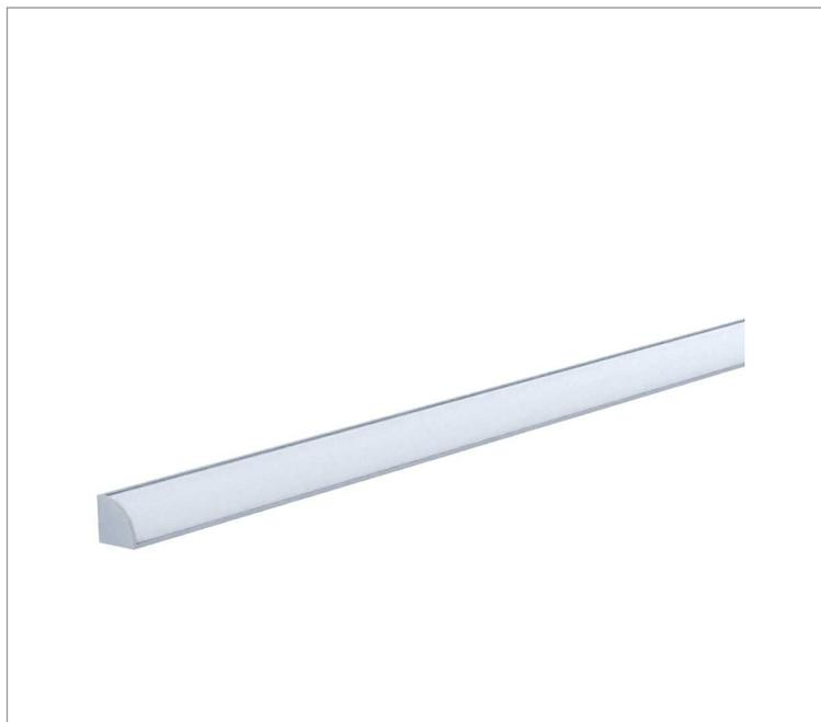
Luminária linear, 15Wm 5000K IRC>80. Corpo em alumínio. Acabamento Branca, Preta ou Especial. Controle óptico principal através de fecho difuso. Luminária grau de proteção IP-20. Driver corrente constante Liga/Desliga, Triac, 1-10V ou Dali (consultar condições). Tensão de trabalho 220V ou Bivolt.
