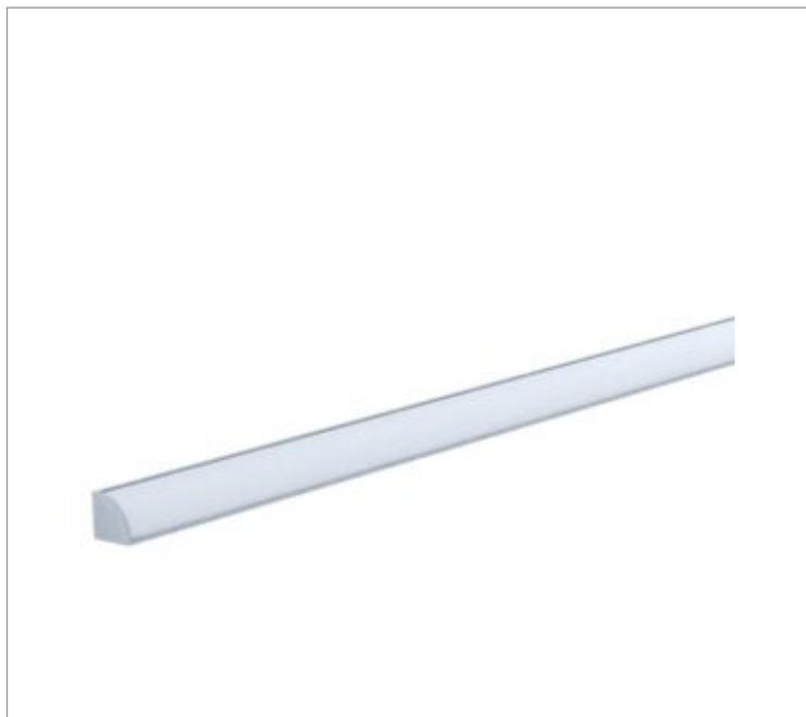
Luminária linear, 25Wm 2700K IRC>80. Corpo em alumínio. Acabamento Branca, Preta ou Especial. Controle óptico principal através de facho difuso. Luminária grau de proteção IP-20ou65 (consultar condições). Driver corrente constante Liga/Desliga, Triac, 1-10V ou Dali (consultar condições). Tensão de trabalho 220V ou Bivolt.
