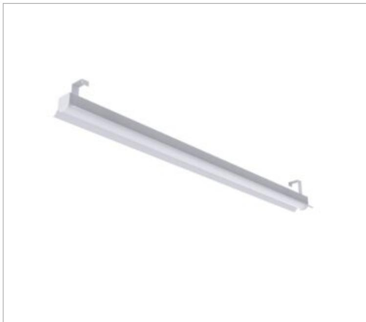
Luminária retangular para perfilado, 20W 5000K IRC>80. Corpo em alumínio. Acabamento Branca. Controle óptico principal através de fecho difuso. Luminária grau de proteção IP-20. Driver corrente constante Liga/Desliga, Triac, 1-10V ou Dali (consultar condições). Tensão de trabalho 220V ou Bivolt.
