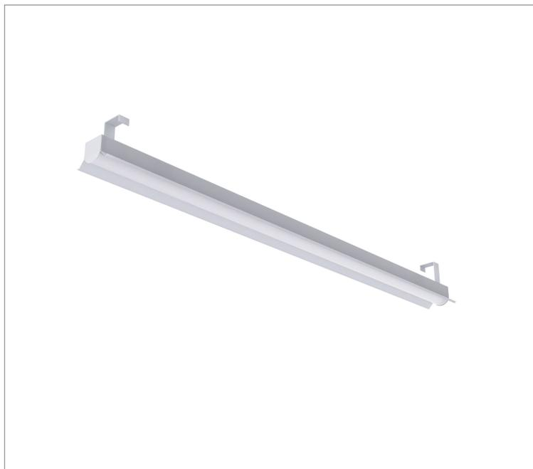
Luminária retangular para perfilado, 56W 5000K IRC>80. Corpo em alumínio. Acabamento Branca. Controle óptico principal através de fecho difuso. Luminária grau de proteção IP-20. Driver corrente constante Liga/Desliga, Triac, 1-10V ou Dali (consultar condições). Tensão de trabalho 220V ou Bivolt.
