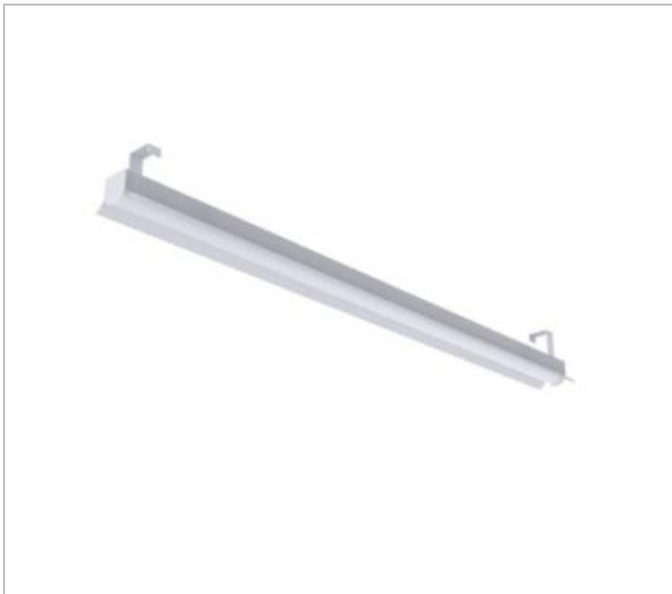
Luminária retangular para perfilado, 56W 4000K IRC>95. Corpo em alumínio. Acabamento Branca. Controle óptico principal através de fecho difuso. Luminária grau de proteção IP-20. Driver corrente constante Liga/Desliga, Triac, 1-10V ou Dali (consultar condições). Tensão de trabalho 220V ou Bivolt.
