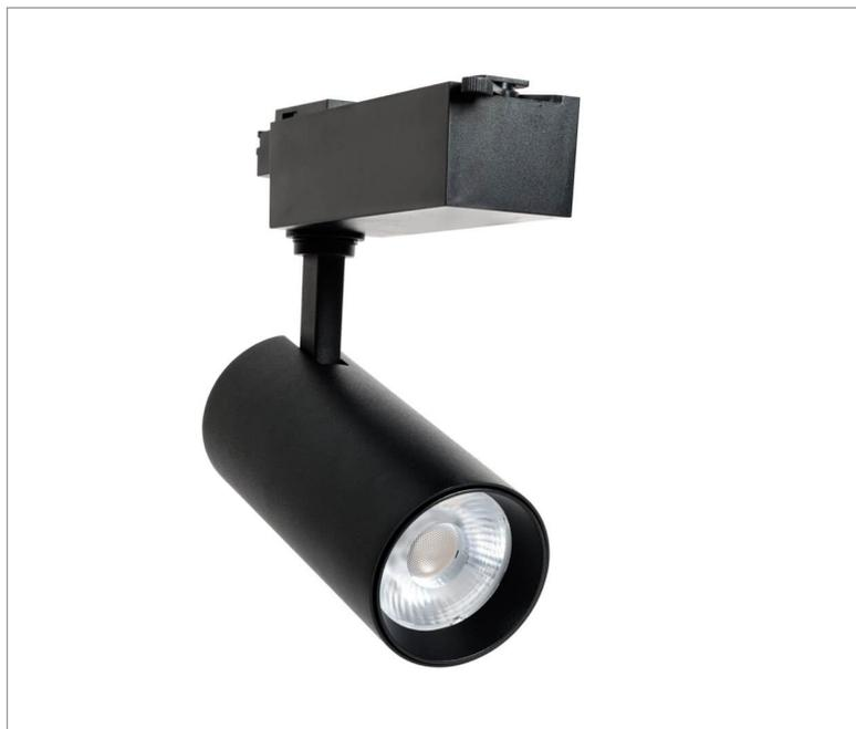
Luminária de trilho, 6W 2500K IRC>95. Corpo em alumínio. Acabamento preto. Controle óptico principal através de lente fecho 50°. Luminária grau de proteção IP-20. Driver corrente constante Liga/Desliga Tensão de trabalho 220V ou Bivolt.
