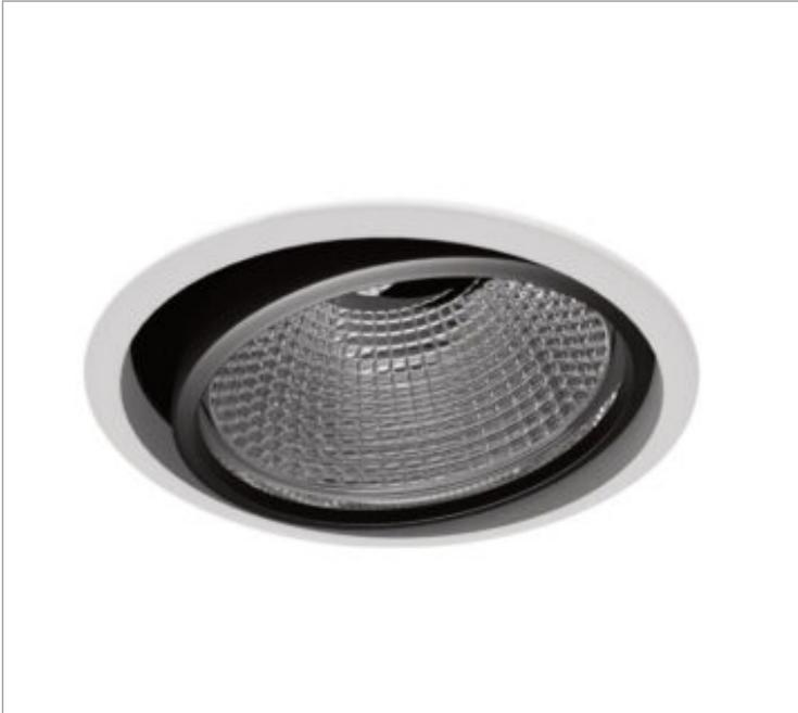
Luminária circular de embutir em forro de gesso, 7W 2700K IRC>80. Corpo em alumínio. Acabamento Branca, Preta ou Especial. Controle óptico principal através de refletor facho 24°. Luminária grau de proteção IP-20. Driver corrente constante Liga/Desliga, Triac, 1-10V ou Dali (consultar condições). Tensão de trabalho 220V ou Bivolt.
