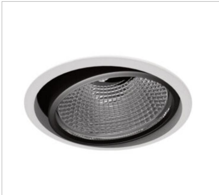
Luminária circular de embutir em forro de gesso, 14W 4000K IRC>80. Corpo em alumínio. Acabamento Branca, Preta ou Especial. Controle óptico principal através de refletor facho 40°. Luminária grau de proteção IP-20. Driver corrente constante Liga/Desliga, Triac, 1-10V ou Dali (consultar condições). Tensão de trabalho 220V ou Bivolt.
