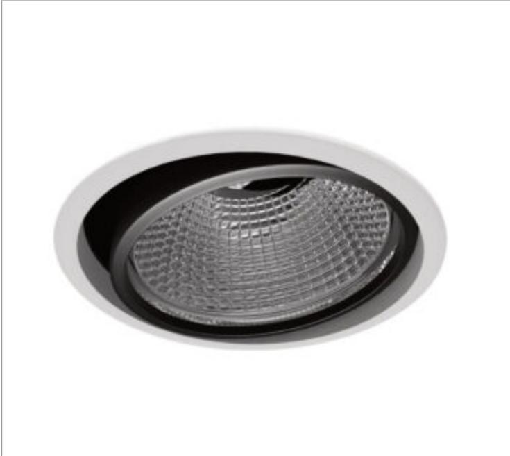
Luminária circular de embutir em forro de gesso, 7W 2700K IRC>80. Corpo em alumínio. Acabamento Branca, Preta ou Especial. Controle óptico principal através de refletor facho 40°. Luminária grau de proteção IP-20. Driver corrente constante Liga/Desliga, Triac, 1-10V ou Dali (consultar condições). Tensão de trabalho 220V ou Bivolt.
