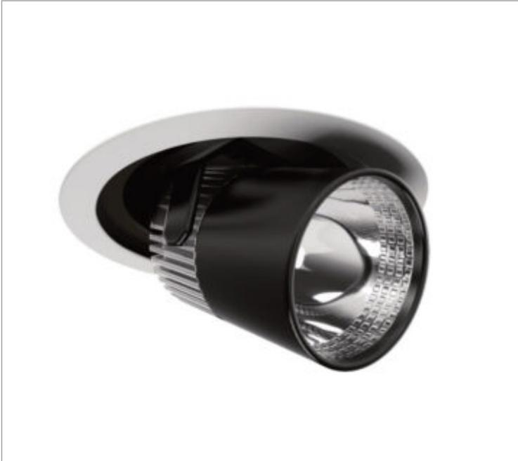
Luminária circular em forro de gesso, 20W 4000K IRC>80. Corpo em alumínio. Acabamento Branca, Preta ou Especial. Controle óptico principal através de refletor facho 40°. Luminária grau de proteção IP-20. Driver corrente constante Liga/Desliga, Triac, 1-10V ou Dali (consultar condições). Tensão de trabalho 220V ou Bivolt.
