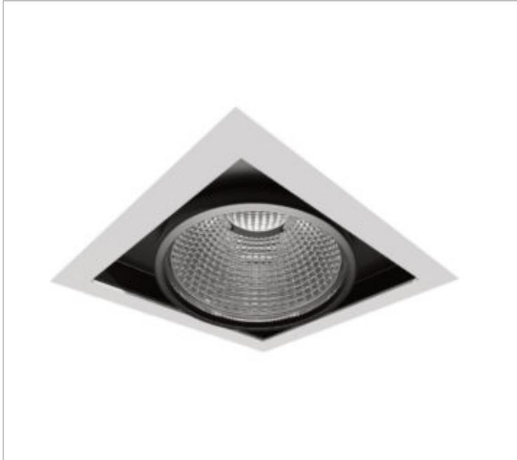
Luminária quadrada de embutir em forro de gesso, 14W 2500K IRC>95. Corpo em alumínio. Acabamento Branca, Preta ou Especial. Controle óptico principal através de refletor facho 24°. Luminária grau de proteção IP-20. Driver corrente constante Liga/Desliga, Triac, 1-10V ou Dali (consultar condições). Tensão de trabalho 220V ou Bivolt.
