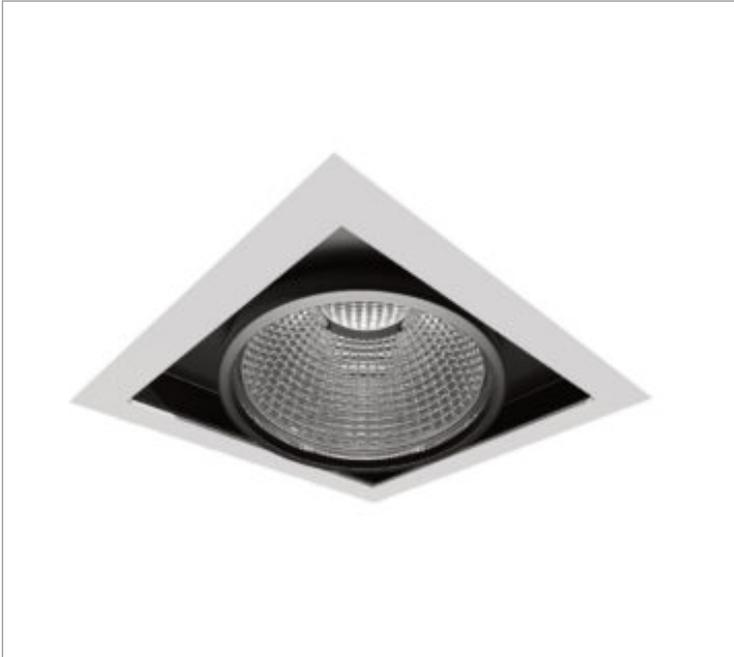
Luminária quadrada de embutir em forro de gesso, 28W 3000K IRC>95. Corpo em alumínio. Acabamento Branca, Preta ou Especial. Controle óptico principal através de refletor facho 24°. Luminária grau de proteção IP-20. Driver corrente constante Liga/Desliga, Triac, 1-10V ou Dali (consultar condições). Tensão de trabalho 220V ou Bivolt.
