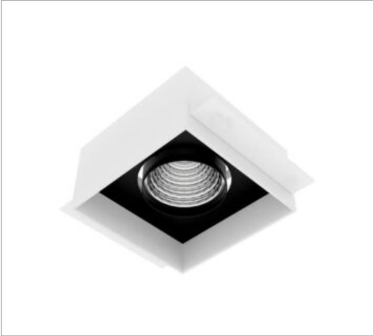
Luminária quadrada de embutir no-frame em forro de gesso, 28W 4000K IRC>80. Corpo em alumínio. Acabamento Branca, Preta ou Especial. Controle óptico principal através de refletor facho 40°. Luminária grau de proteção IP-20. Driver corrente constante Liga/Desliga, Triac, 1-10V ou Dali (consultar condições). Tensão de trabalho 220V ou Bivolt.
