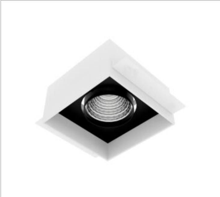
Luminária quadrada de embutir no-frame em forro de gesso, 42W 2500K IRC>95. Corpo em alumínio. Acabamento Branca, Preta ou Especial. Controle óptico principal através de refletor facho 60°. Luminária grau de proteção IP-20. Driver corrente constante Liga/Desliga, Triac, 1-10V ou Dali (consultar condições). Tensão de trabalho 220V ou Bivolt.
