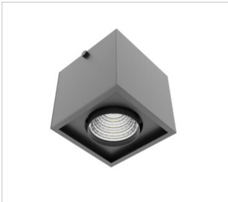
Luminária quadrada de sobrepor, 14W 3000K IRC>95. Corpo em alumínio. Acabamento Branca, Preta ou Especial. Controle óptico principal através de refletor fecho 40°. Luminária grau de proteção IP-20. Driver corrente constante Liga/Desliga, Triac, 1-10V ou Dali (consultar condições). Tensão de trabalho 220V ou Bivolt.
