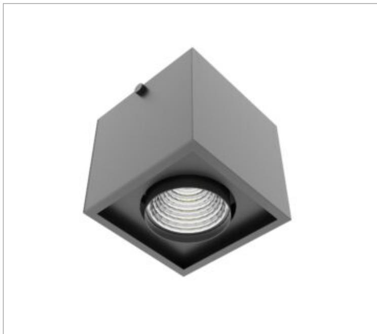
Luminária quadrada de sobrepor, 28W 4000K IRC>90. Corpo em alumínio. Acabamento Branca, Preta ou Especial. Controle óptico principal através de refletor facho 40°. Luminária grau de proteção IP-20. Driver corrente constante Liga/Desliga, Triac, 1-10V ou Dali (consultar condições). Tensão de trabalho 220V ou Bivolt.
