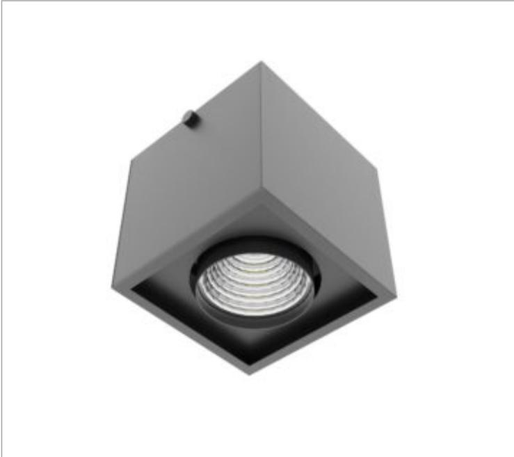
Luminária quadrada de sobrepor, 7W 4000K IRC>90. Corpo em alumínio. Acabamento Branca, Preta ou Especial. Controle óptico principal através de refletor facho 40°. Luminária grau de proteção IP-20. Driver corrente constante Liga/Desliga, Triac, 1-10V ou Dali (consultar condições). Tensão de trabalho 220V ou Bivolt.
