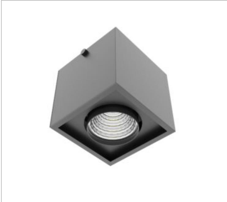
Luminária quadrada de sobrepor, 7W 3000K IRC>95. Corpo em alumínio. Acabamento Branca, Preta ou Especial. Controle óptico principal através de refletor facho 60°. Luminária grau de proteção IP-20. Driver corrente constante Liga/Desliga, Triac, 1-10V ou Dali (consultar condições). Tensão de trabalho 220V ou Bivolt.
