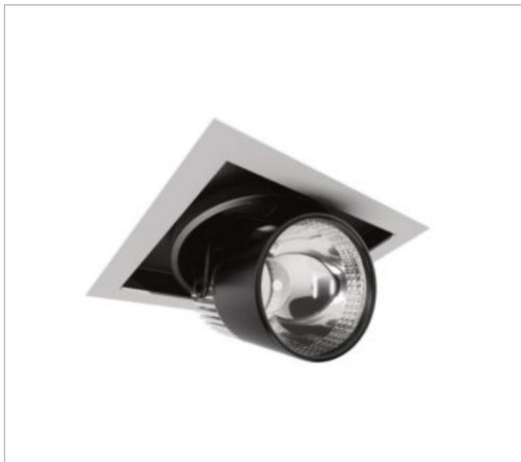
Luminária quadrada em forro de gesso, 42W 2500K IRC>95. Corpo em alumínio. Acabamento Branca, Preta ou Especial. Controle óptico principal através de refletor fecho 24°. Luminária grau de proteção IP-20. Driver corrente constante Liga/Desliga, Triac, 1-10V ou Dali (consultar condições). Tensão de trabalho 220V ou Bivolt.
