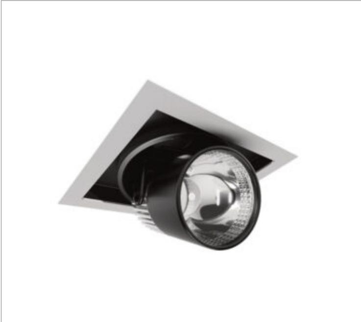
Luminária quadrada em forro de gesso, 7W 4000K IRC>90. Corpo em alumínio. Acabamento Branca, Preta ou Especial. Controle óptico principal através de refletor facho 24°. Luminária grau de proteção IP-20. Driver corrente constante Liga/Desliga, Triac, 1-10V ou Dali (consultar condições). Tensão de trabalho 220V ou Bivolt.
