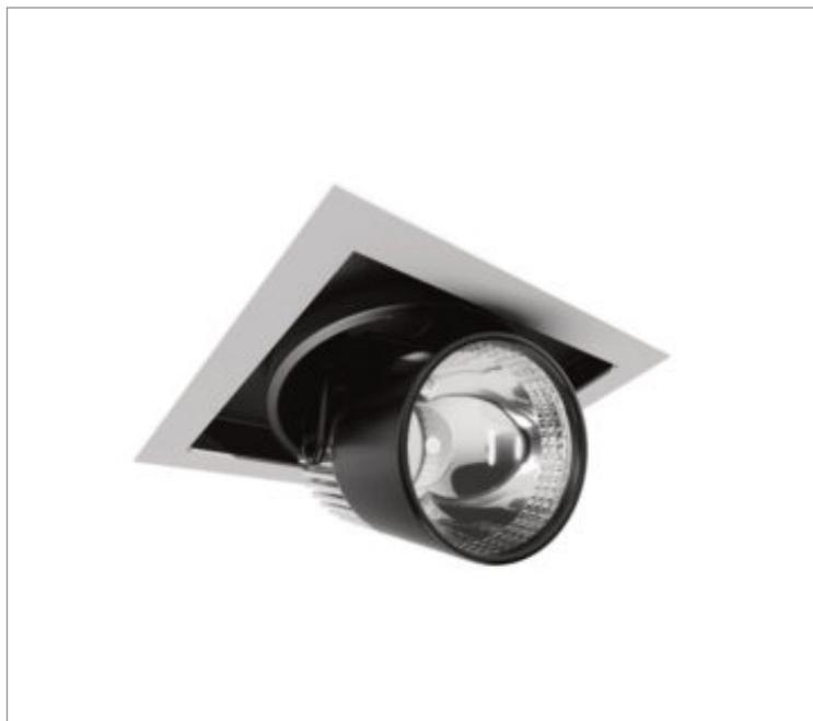
Luminária quadrada em forro de gesso, 42W 2500K IRC>95. Corpo em alumínio. Acabamento Branca, Preta ou Especial. Controle óptico principal através de refletor facho 40°. Luminária grau de proteção IP-20. Driver corrente constante Liga/Desliga, Triac, 1-10V ou Dali (consultar condições). Tensão de trabalho 220V ou Bivolt.
