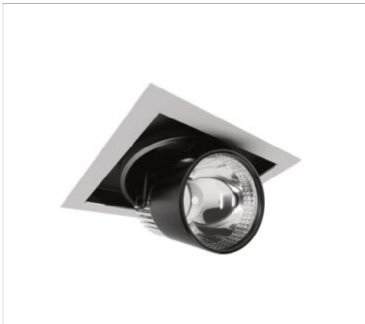
Luminária quadrada em forro de gesso, 7W 2700K IRC>80. Corpo em alumínio. Acabamento Branca, Preta ou Especial. Controle óptico principal através de refletor facho 40°. Luminária grau de proteção IP-20. Driver corrente constante Liga/Desliga, Triac, 1-10V ou Dali (consultar condições). Tensão de trabalho 220V ou Bivolt.
