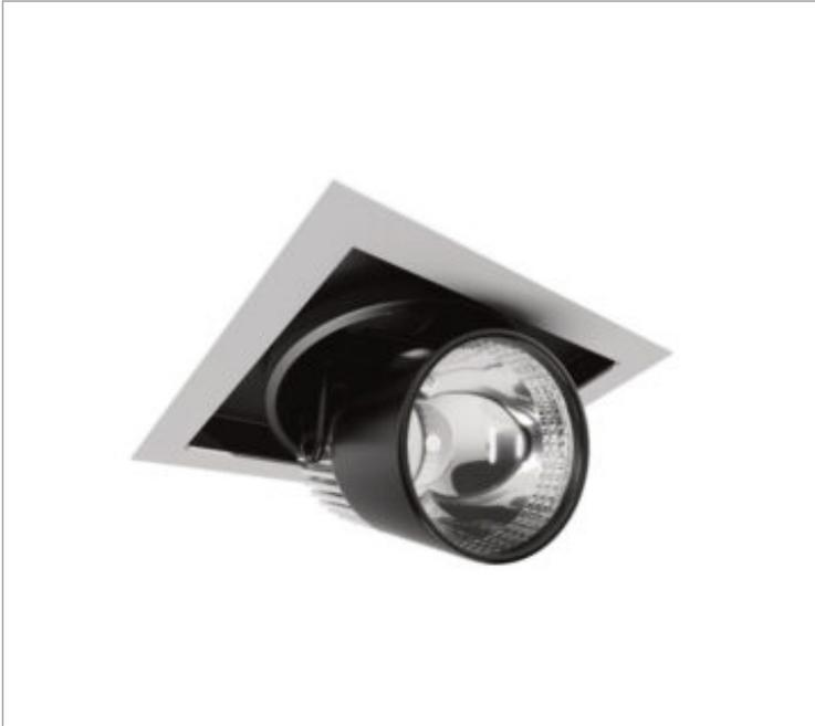
Luminária quadrada em forro de gesso, 7W 3000K IRC>95. Corpo em alumínio. Acabamento Branca, Preta ou Especial. Controle óptico principal através de refletor facho 40°. Luminária grau de proteção IP-20. Driver corrente constante Liga/Desliga, Triac, 1-10V ou Dali (consultar condições). Tensão de trabalho 220V ou Bivolt.
