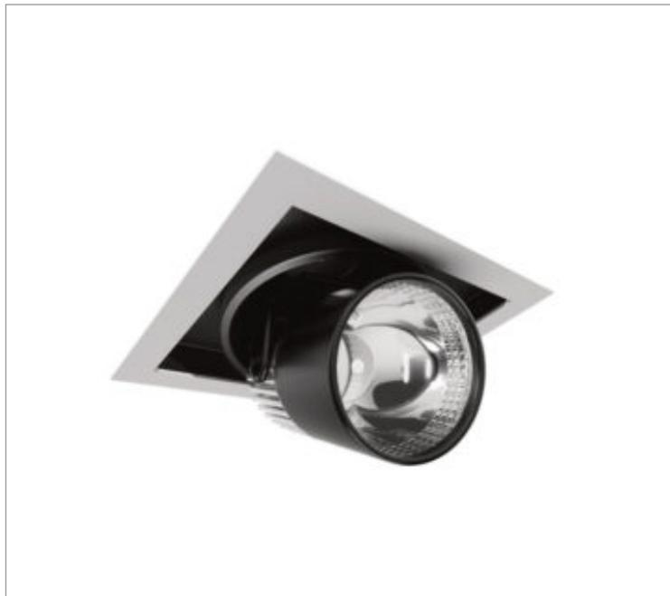
Luminária quadrada em forro de gesso, 28W 3000K IRC>95. Corpo em alumínio. Acabamento Branca, Preta ou Especial. Controle óptico principal através de refletor facho 60°. Luminária grau de proteção IP-20. Driver corrente constante Liga/Desliga, Triac, 1-10V ou Dali (consultar condições). Tensão de trabalho 220V ou Bivolt.
