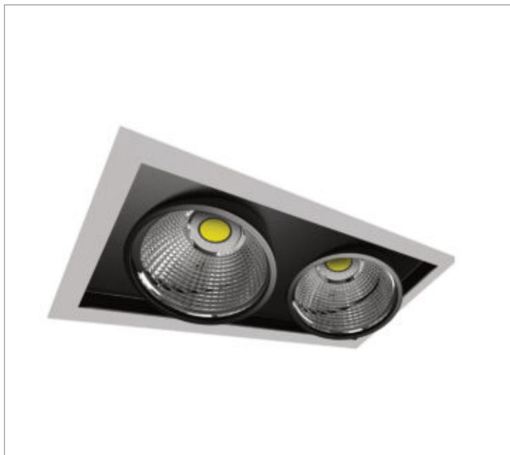
Luminária retangular de embutir em forro de gesso, 2X14W 4000K IRC>90. Corpo em alumínio. Acabamento Branca, Preta ou Especial. Controle óptico principal através de refletor facho 24°. Luminária grau de proteção IP-20. Driver corrente constante Liga/Desliga, Triac, 1-10V ou Dali (consultar condições). Tensão de trabalho 220V ou Bivolt.
