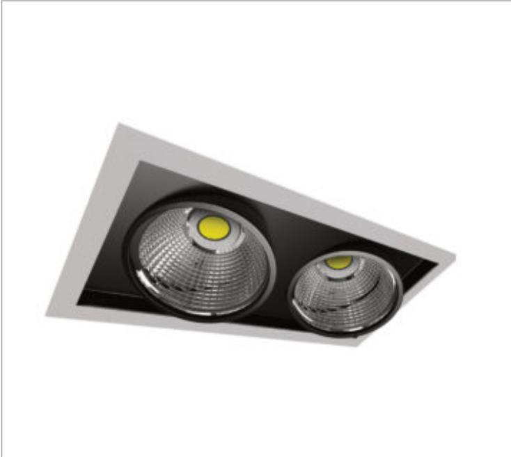
Luminária retangular de embutir em forro de gesso, 2X20W 3000K IRC>90. Corpo em alumínio. Acabamento Branca, Preta ou Especial. Controle óptico principal através de refletor facho 60°. Luminária grau de proteção IP-20. Driver corrente constante Liga/Desliga, Triac, 1-10V ou Dali (consultar condições). Tensão de trabalho 220V ou Bivolt.
