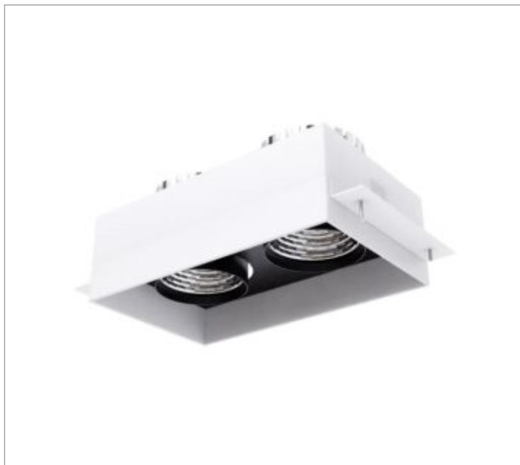
Luminária retangular de embutir no-frame em forro de gesso, 2X28W 4000K IRC>90. Corpo em alumínio. Acabamento Branca, Preta ou Especial. Controle óptico principal através de refletor facho 24°. Luminária grau de proteção IP-20. Driver corrente constante Liga/Desliga, Triac, 1-10V ou Dali (consultar condições). Tensão de trabalho 220V ou Bivolt.
