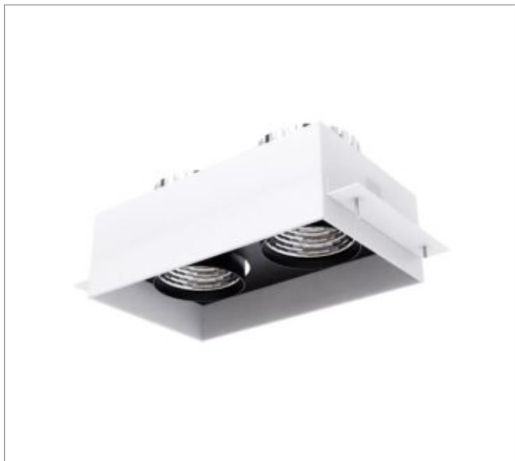
Luminária retangular de embutir no-frame em forro de gesso, 2X42W 2700K IRC>80. Corpo em alumínio. Acabamento Branca, Preta ou Especial. Controle óptico principal através de refletor facho 60°. Luminária grau de proteção IP-20. Driver corrente constante Liga/Desliga, Triac, 1-10V ou Dali (consultar condições). Tensão de trabalho 220V ou Bivolt.
