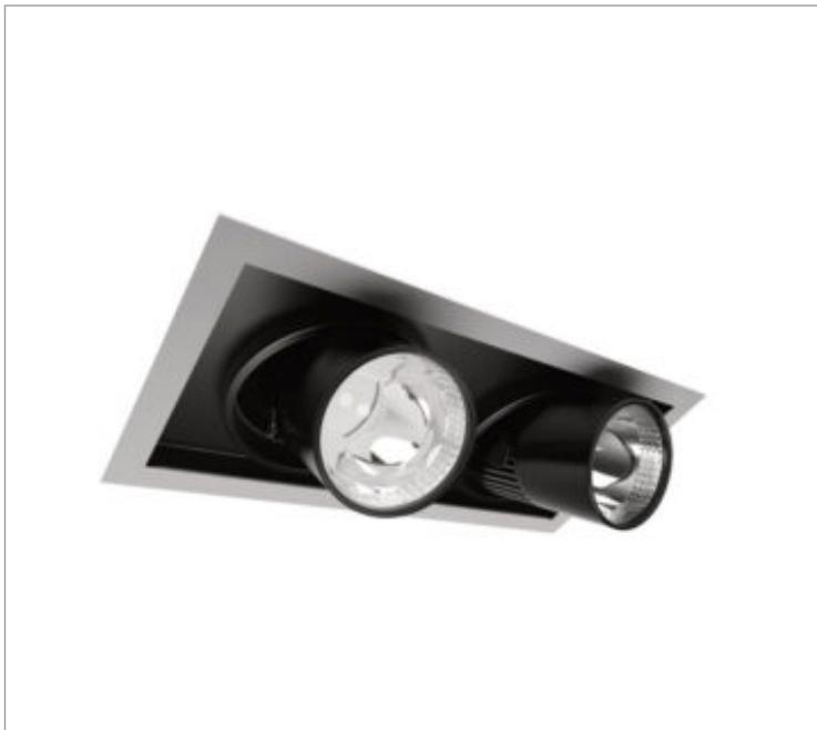
Luminária retangular em forro de gesso, 2X20W 2500K IRC>95. Corpo em alumínio. Acabamento Branca, Preta ou Especial. Controle óptico principal através de refletor facho 24°. Luminária grau de proteção IP-20. Driver corrente constante Liga/Desliga, Triac, 1-10V ou Dali (consultar condições). Tensão de trabalho 220V ou Bivolt.
