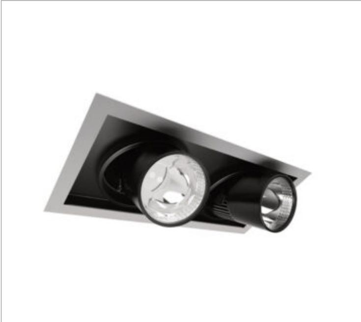
Luminária retangular em forro de gesso, 2X14W 3000K IRC>95. Corpo em alumínio. Acabamento Branca, Preta ou Especial. Controle óptico principal através de refletor facho 60°. Luminária grau de proteção IP-20. Driver corrente constante Liga/Desliga, Triac, 1-10V ou Dali (consultar condições). Tensão de trabalho 220V ou Bivolt.
