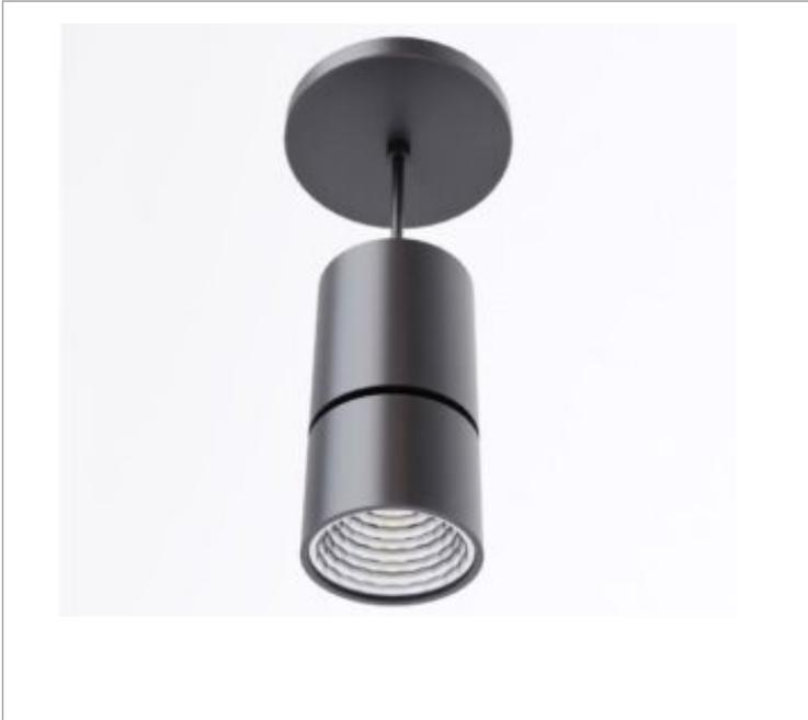
Luminária pendente iluminação direta, 14W 2700K IRC>90. Corpo em alumínio. Acabamento Branca, Preta ou Especial. Controle óptico principal através de refletor facho 24°. Luminária grau de proteção IP-20. Driver corrente constante Liga/Desliga, Triac, 1-10V ou Dali (consultar condições). Tensão de trabalho 220V ou Bivolt.
