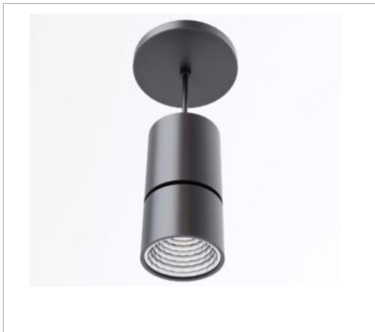
Luminária pendente iluminação direta, 20W 2700K IRC>90. Corpo em alumínio. Acabamento Branca, Preta ou Especial. Controle óptico principal através de refletor facho 24°. Luminária grau de proteção IP-20. Driver corrente constante Liga/Desliga, Triac, 1-10V ou Dali (consultar condições). Tensão de trabalho 220V ou Bivolt.
