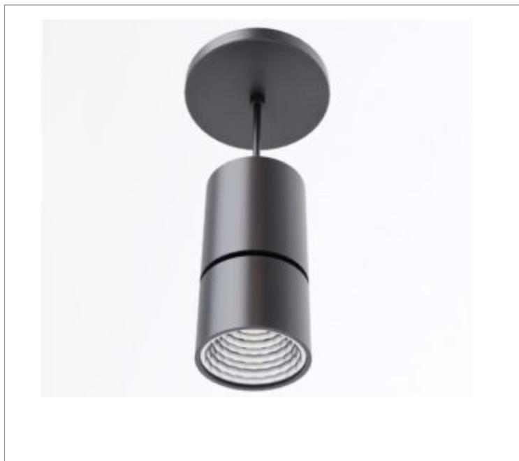
Luminária pendente iluminação direta, 7W 2700K IRC>80. Corpo em alumínio. Acabamento Branca, Preta ou Especial. Controle óptico principal através de refletor facho 24°. Luminária grau de proteção IP-20. Driver corrente constante Liga/Desliga, Triac, 1-10V ou Dali (consultar condições). Tensão de trabalho 220V ou Bivolt.
