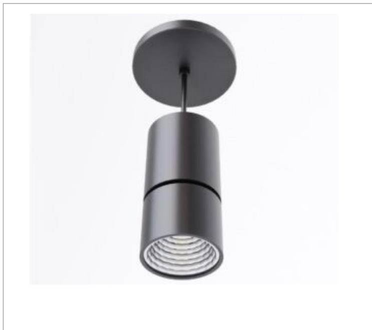
Luminária pendente iluminação direta, 7W 3000K IRC>80. Corpo em alumínio. Acabamento Branca, Preta ou Especial. Controle óptico principal através de refletor facho 24°. Luminária grau de proteção IP-20. Driver corrente constante Liga/Desliga, Triac, 1-10V ou Dali (consultar condições). Tensão de trabalho 220V ou Bivolt.
