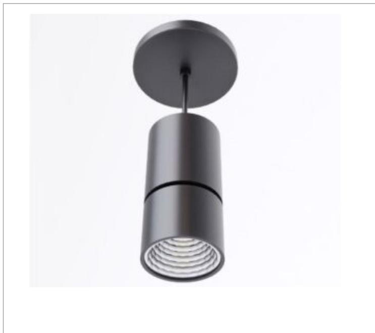
Luminária pendente iluminação direta, 28W 2500K IRC>95. Corpo em alumínio. Acabamento Branca, Preta ou Especial. Controle óptico principal através de refletor facho 40°. Luminária grau de proteção IP-20. Driver corrente constante Liga/Desliga, Triac, 1-10V ou Dali (consultar condições). Tensão de trabalho 220V ou Bivolt.
