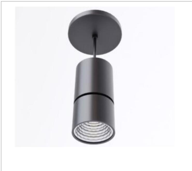
Luminária pendente iluminação direta, 7W 4000K IRC>90. Corpo em alumínio. Acabamento Branca, Preta ou Especial. Controle óptico principal através de refletor facho 40°. Luminária grau de proteção IP-20. Driver corrente constante Liga/Desliga, Triac, 1-10V ou Dali (consultar condições). Tensão de trabalho 220V ou Bivolt.
