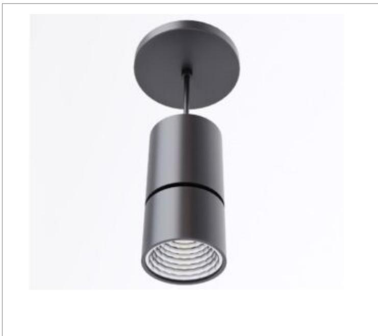
Luminária pendente iluminação direta, 7W 2700K IRC>90. Corpo em alumínio. Acabamento Branca, Preta ou Especial. Controle óptico principal através de refletor facho 60°. Luminária grau de proteção IP-20. Driver corrente constante Liga/Desliga, Triac, 1-10V ou Dali (consultar condições). Tensão de trabalho 220V ou Bivolt.
